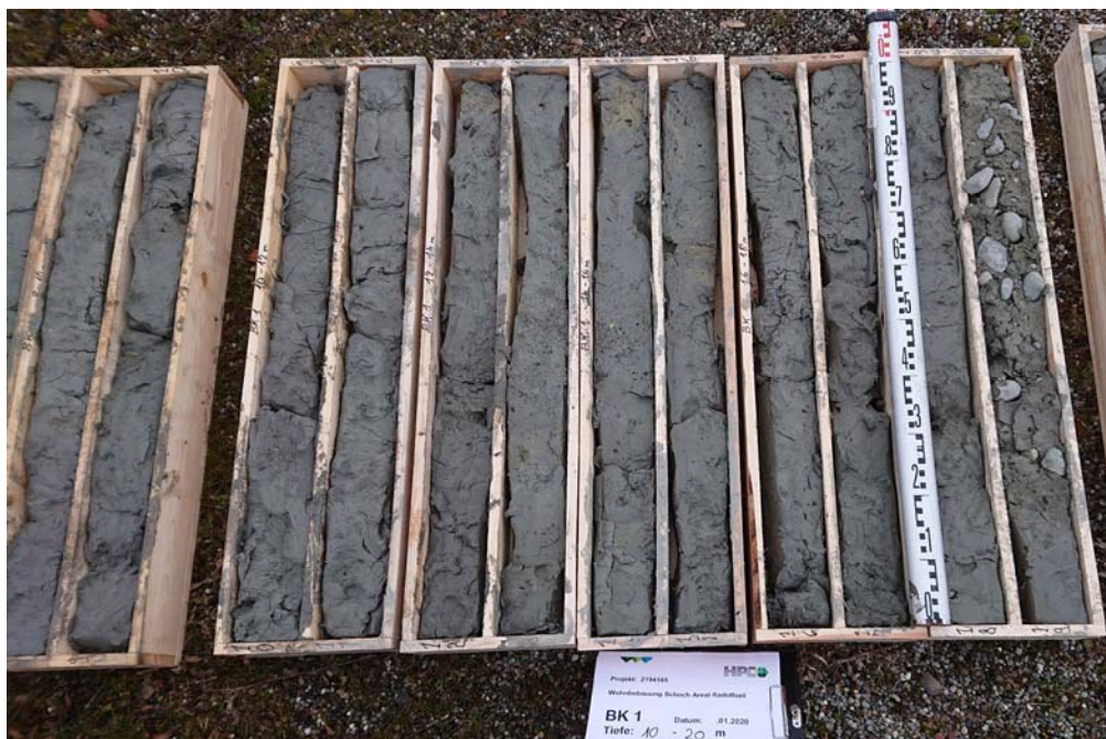
Foto 3: Bohrkern BK 1, 10 – 20 m
