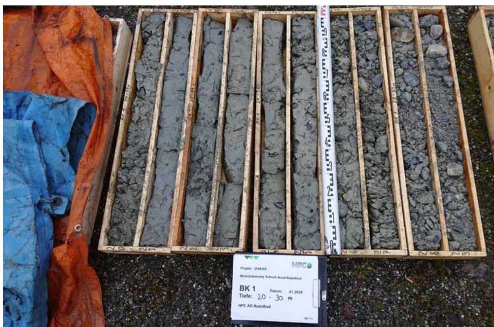
Foto 4: Bohrkern BK 1, 20 – 30 m
